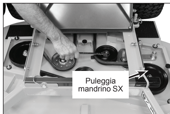
taglio da 42" e 48": Rimozione della cinghia dalla puleggia del mandrino di sinistra
