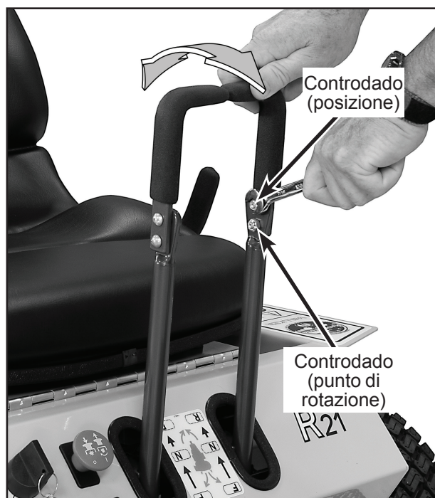
Regolazione dell'impugnatura dello sterzo
