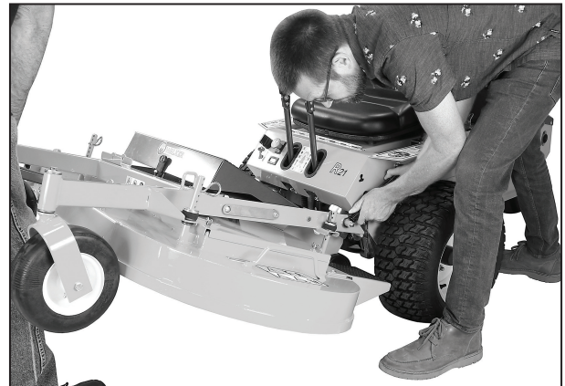
Installare la molla del contrappeso sul telaio
