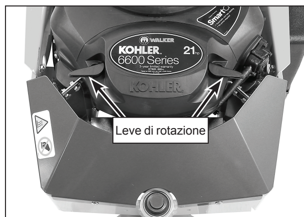
Sbloccare il coperchio del filtro dell'aria
