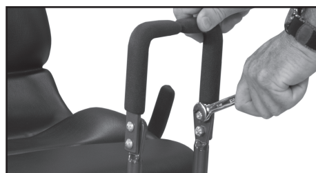
Maniglie della leva dello sterzo installate
