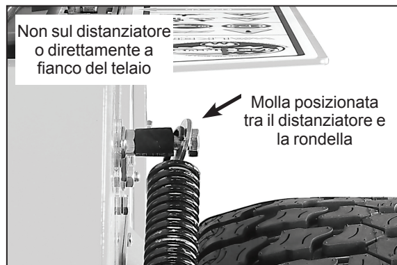
Molla del contrappeso installata sul montante del trattore
