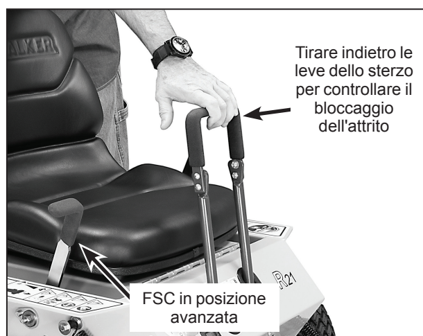
Test di regolazione dell'attrito FSC
