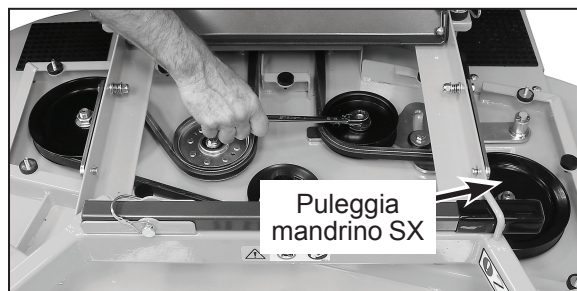
taglio da 42" e 48": Rimozione della cinghia dalla puleggia del mandrino di sinistra
