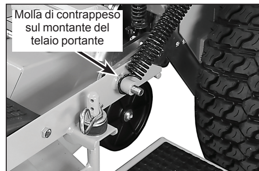
Molla del contrappeso sul telaio portante
