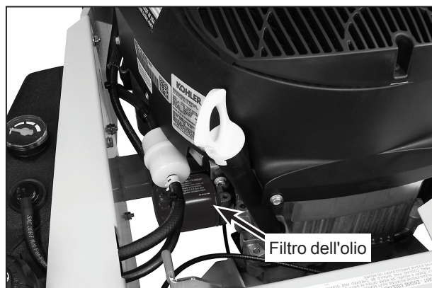
Posizione del filtro dell'olio (sotto il filtro del carburante)
