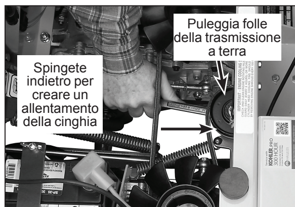
Ruotare il braccio della trasmissione a terra per allentare la cinghia.
