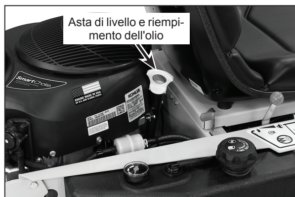
Asta di livello e posizione di riempimento dell'olio
