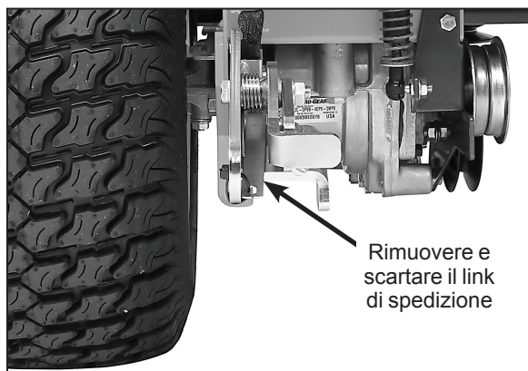
Maglia di spedizione sul braccio di supporto del ponte destro
