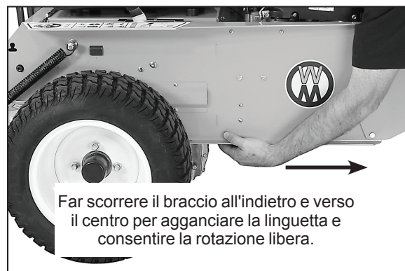
Inserire il blocco dell'asse di trasmissione (figura a sinistra)
