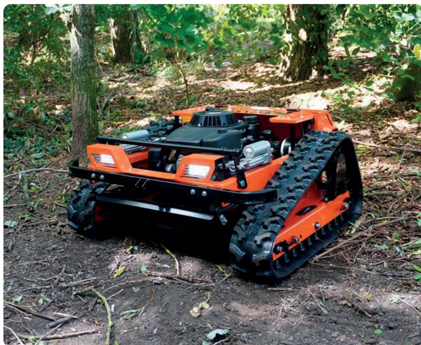
Robot radio comandato con 55 cm di taglio con trazione su cingoli per affrontare salite importanti.
