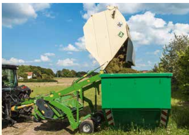
Con un'altezza massima di 2,3 m, è possibile svuotare il cestello anche in rimorchi alti o container grandi
