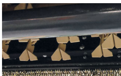
Rulli di supporto rivestiti in poliuretano
