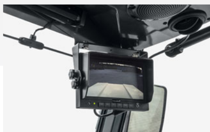
Videocamera di retromarcia per una maggiore visibilità 3
