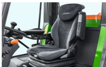
Diverse opzioni di sedile, come il sedile Grammer "De Luxe" con sospensioni pneumatiche e riscaldamento
